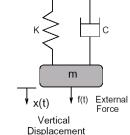
$$G(s) = \begin{bmatrix} 1 & 0 \end{bmatrix} \begin{bmatrix} s & -1 \\ \frac{k}{m} & s + \frac{b}{m} \end{bmatrix}^{-1} \begin{bmatrix} 0 \\ \frac{1}{m} \end{bmatrix}$$
