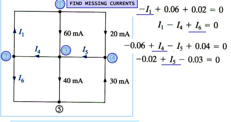
KCL DEPENDS ONLY ON THE INTERCONNECTION. THE TYPE OF COMPONENT IS IRRELEVANT
