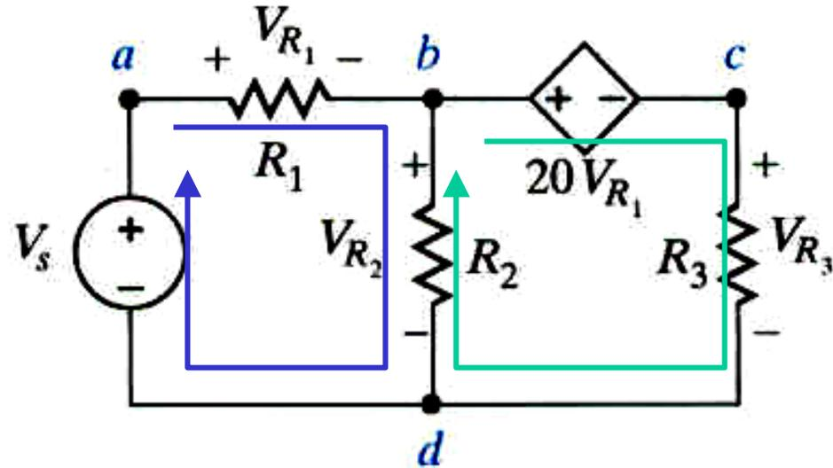
$$V_{R1} + V_{R2} - V_S = 0$$
