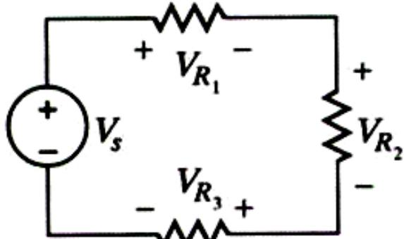
$$-V_S + V_{R_1} + V_{R_2} + V_{R_3} = 0$$
